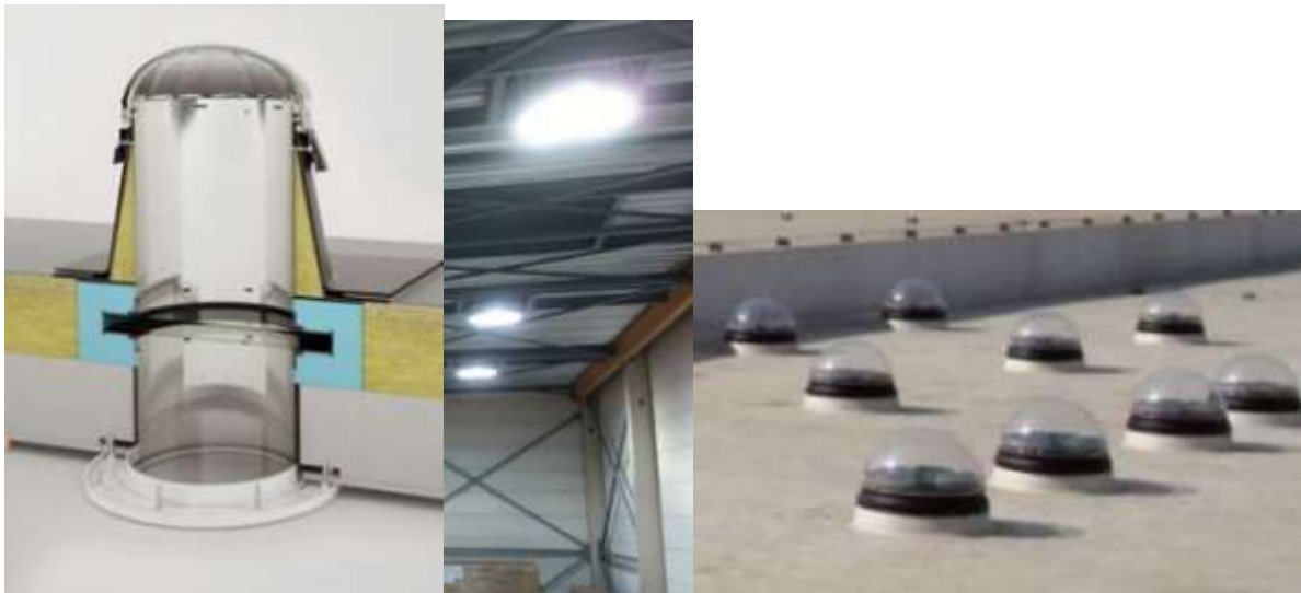
Figuur 51. Doorsnede en geplaatste daglichtbuizen. 27
