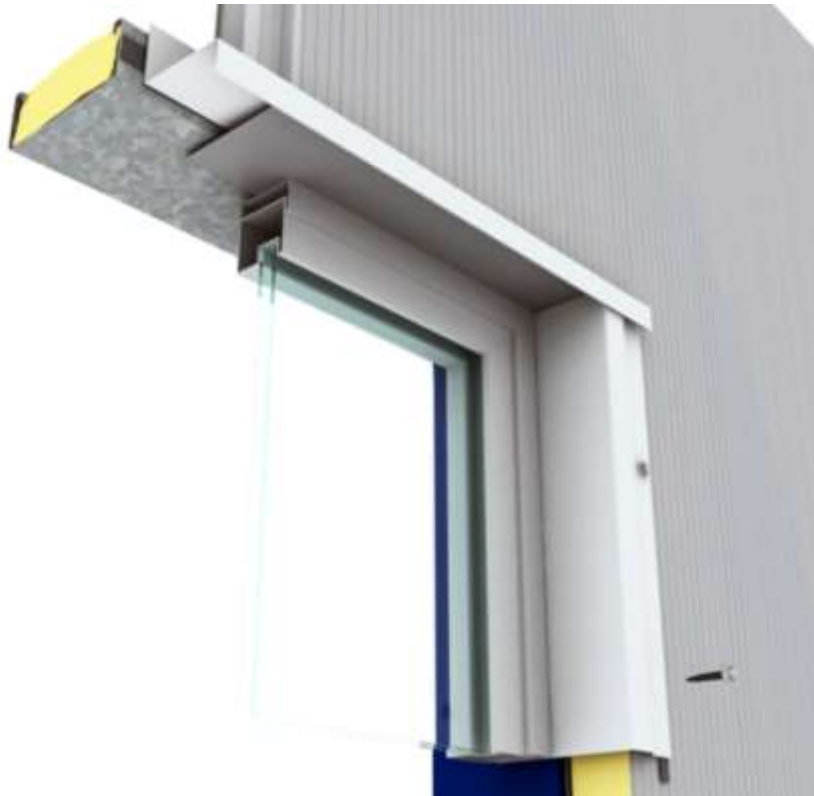
Figuur 80. Plaatsing zonder aandacht voor bouwknopen en luchtdichtheid. 35
