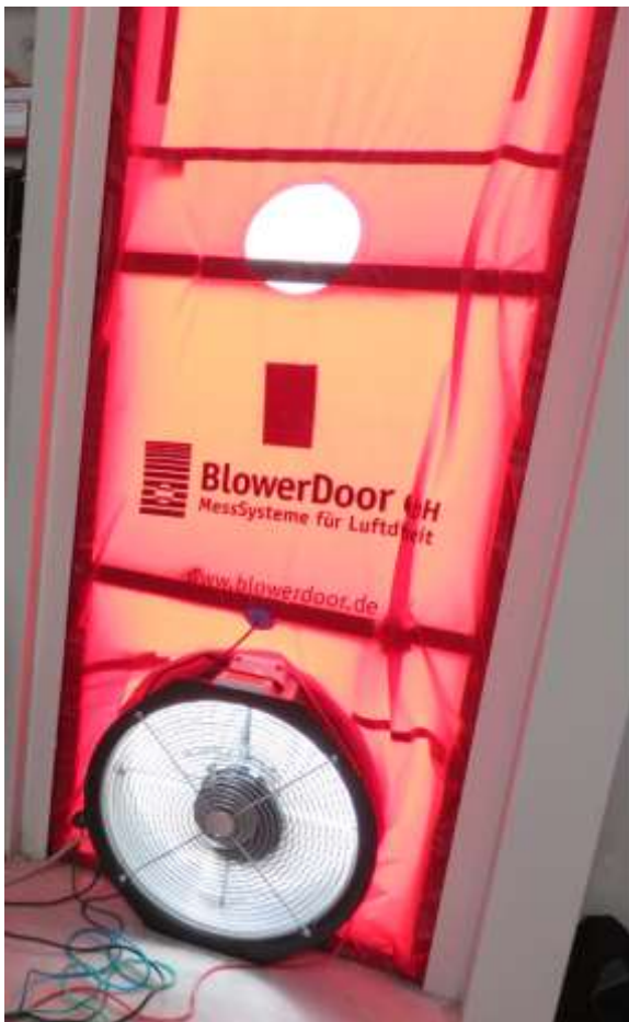
Afbeelding 1. Ventilator geplaatst in deuropening
